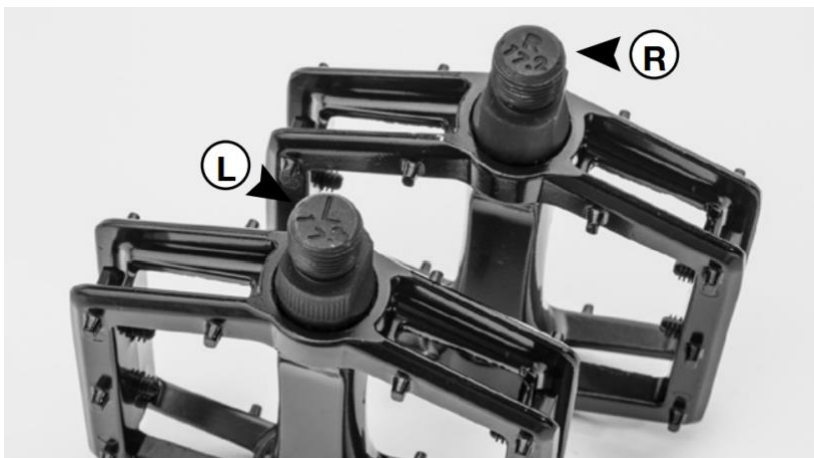
Figure 11. Filet de la pédale. Veillez à tourner dans le bon sens.
