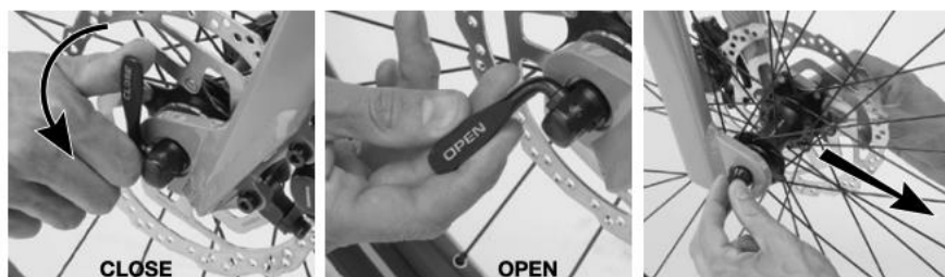
Figure 14: Les étapes du serrage de l'essieu.
