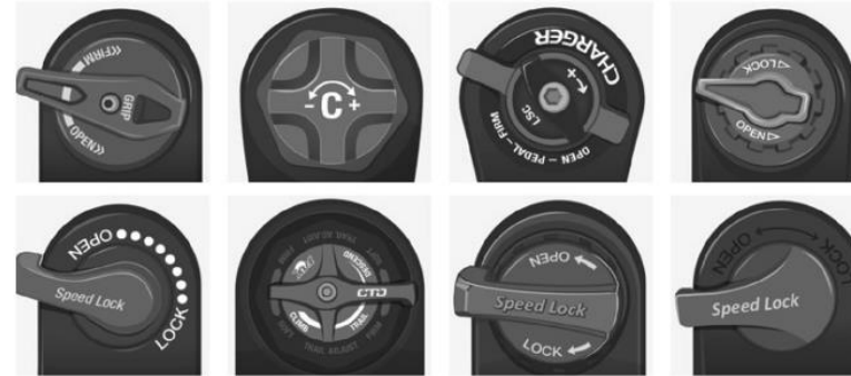
Figure 17: Différents systèmes de blocage des fourches.
