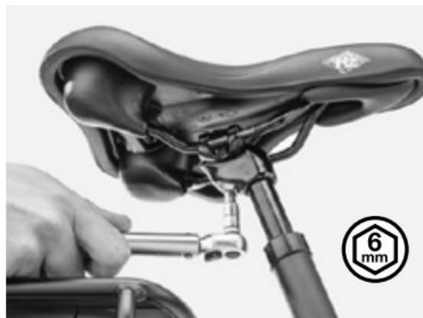
Figure 5. Serrer / desserrer le boulon de selle simple
