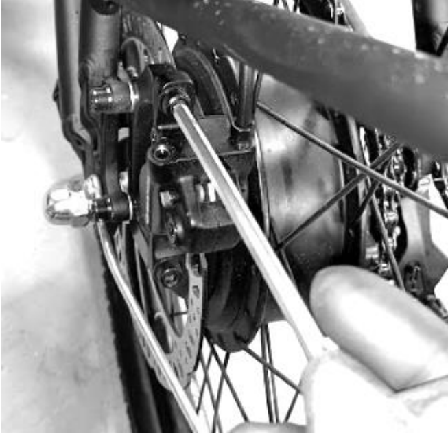
Figure 21: Dévisser les boulons de fixation pour retirer l'étrier
