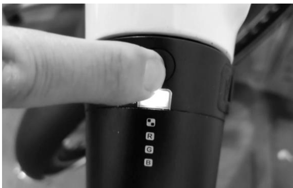
Figure 30: Bouton d'alimentation de la batterie
