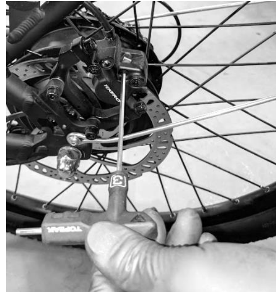
Figure 22: Desserrer le boulon de fixation de la plaquette
