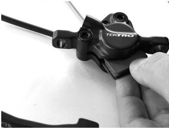
Figure 23: Pousser doucement sur la partie supérieure des plaquettes pour les faire glisser.
