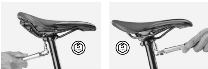
Figure 6. Serrer / desserrer le boulon de la selle simple
