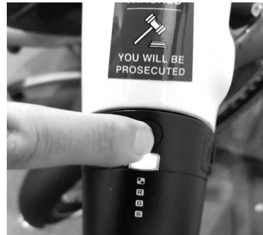
Figure 25: Bouton d'alimentation de la batterie
