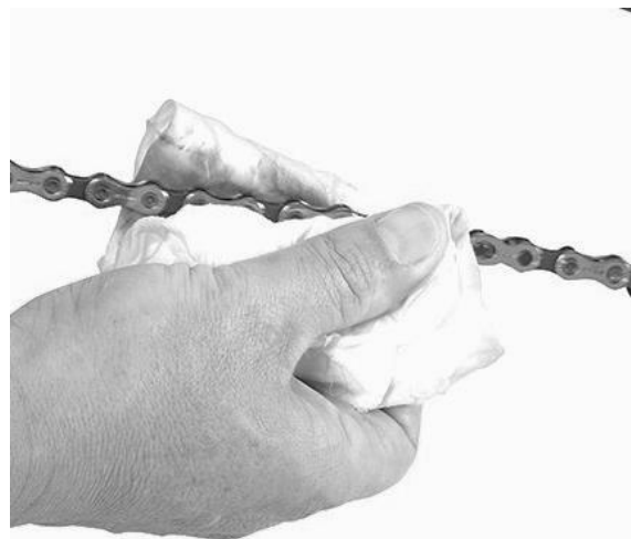
Figure 25 : Utilisez un chiffon pour enlever les débris et la saleté de la chaîne. Tournez doucement la pédale avec la roue arrière surélevée pour la nettoyer. L'eau savonneuse est la meilleure solution de nettoyage. Dans la mesure du possible, évitez les dégraissants lourds.
