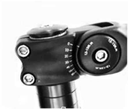
Figure 11. Desserrer le boulon M5 (au centre)
