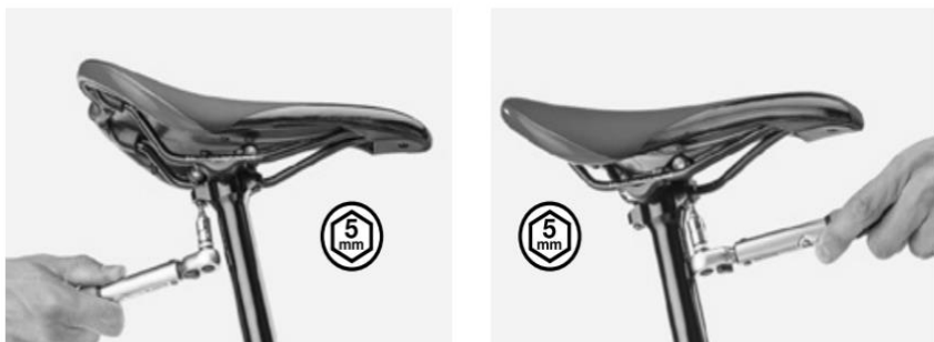
Figure 6. Serrer / desserrer le boulon de selle simple
