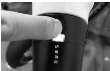
Figure 37 : Appuyez sur le bouton de la pile et maintenez-le enfoncé jusqu'à ce que la lumière s'éteigne.
