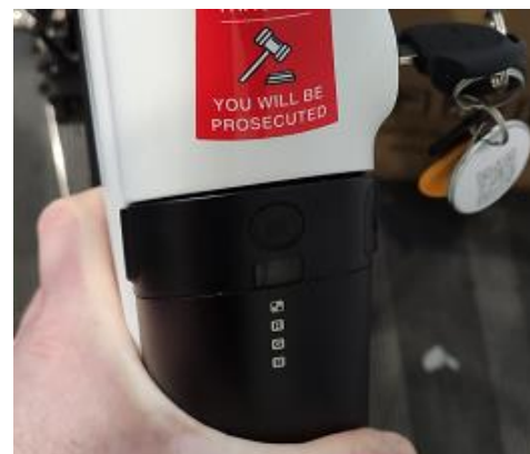
Figure 39 : Insertion de la batterie
