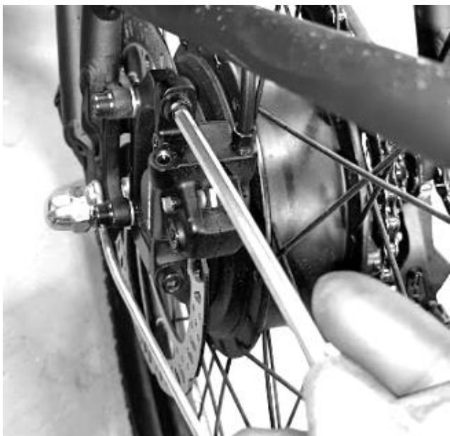
Figure 27 : Desserrer les boulons de fixation pour retirer l'étrier Desserrer le boulon de retenue du coussin à l'aide d'un outil hexagonal M3
