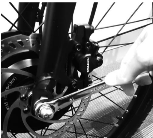
Figure 15 : Serrer l'écrou à 35nm
