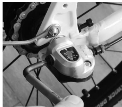
Figure 18 : Tournez l'écrou du levier de vitesses m5 dans le sens inverse des aiguilles d'une montre. Après quelques rotations, le mécanisme se détache
