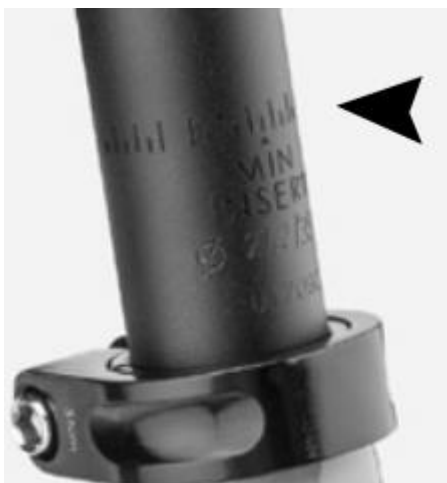
Figure 3. Insertion minimale au niveau de la tige de selle
