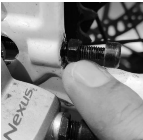
Figure 24 : Assurez-vous que l'écrou de retenue est serré contre le cadre pour arrêter le mouvement de l'essieu.
