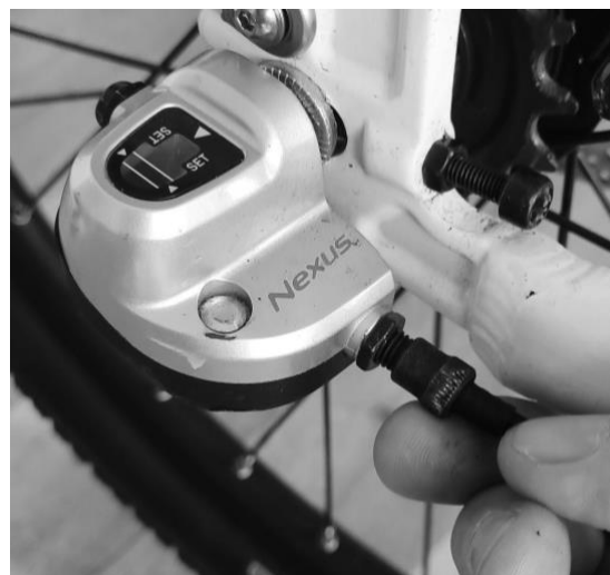
Figure 21 : Ajustez le canon en le tournant dans un sens ou dans l'autre
