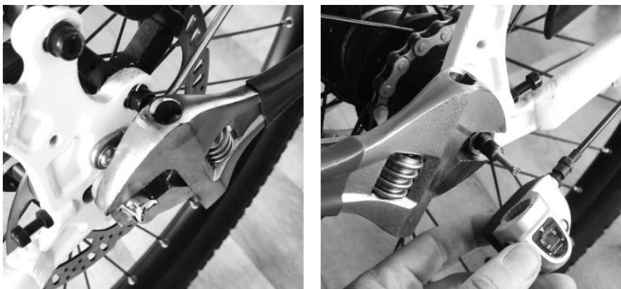
Figure 17 : Serrage des écrous de l'essieu du côté de la chaîne (à droite) et du côté opposé (à gauche).
