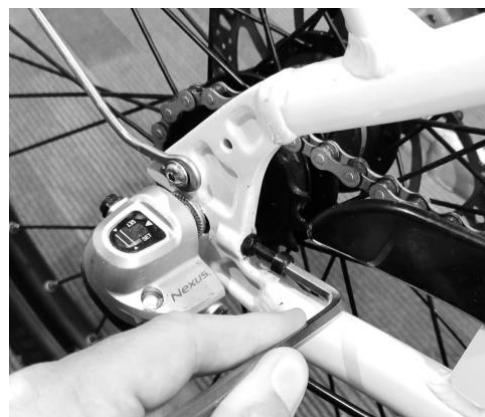
Figure 16 : Régler la tension de l'essieu en tournant le boulon dans le sens des aiguilles d'une montre. S'assurer que le boulon du côté opposé est également réglé.
