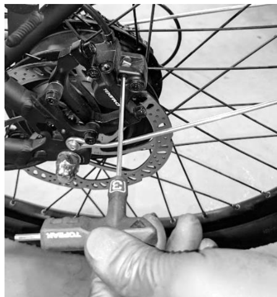
Figure 28 : Desserrer le boulon de fixation de la plaquette
