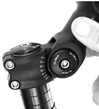
Figure 12. Réglage de la position de la potence
