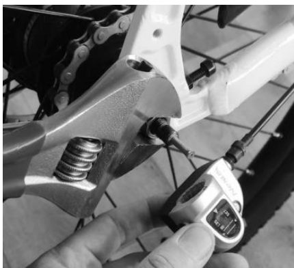
Figure 19 : Réglage de l'écrou de l'essieu côté commande.
