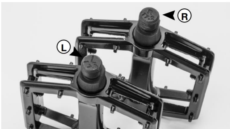
Figure 13. Filetage de la pédale. Veillez à tourner dans le bon sens.
