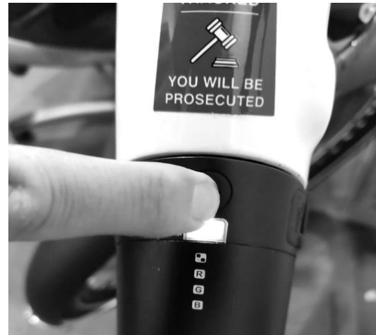
Figure 31 : Appuyer sur le bouton et le maintenir enfoncé pour allumer
