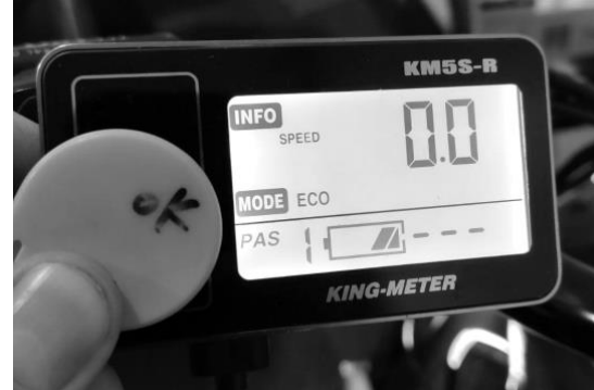
Figure 33 : Scanner le RFID jaune pour activer le système
